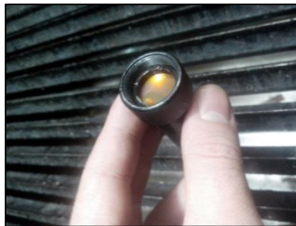
Figura 17: Lente colimadora “menisco”.
