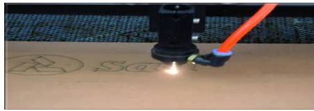
Figura 20: Gravação a laser em uma placa de madeira [17].
