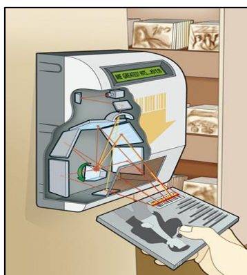
Figura 26: Trajetória do laser na leitura de códigos de barras [27].
